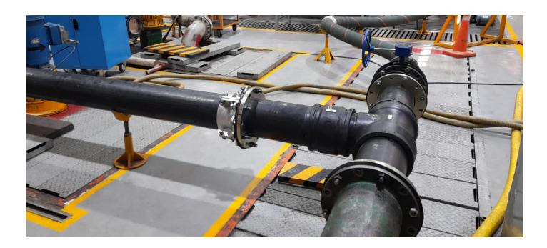
Reemplazo de tuberías de acero por Pexgol para ensayo de bombas centrífugas.
